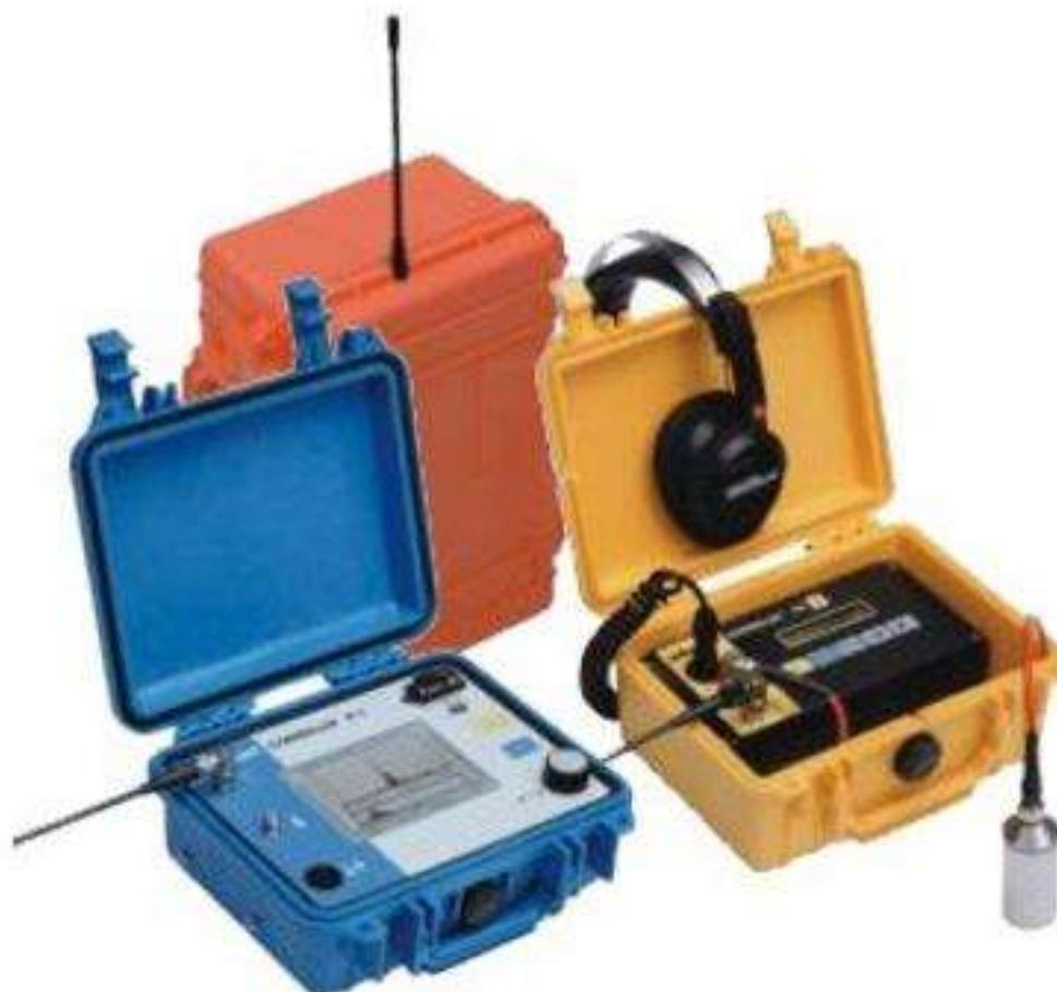
**Correlux P2** è un correlatore utilizzato per la localizzazione di perdite idriche lungo le tubazioni dell'acqua potabile. L'acqua sotto pressione che fuoriesce da un foro origina un rumore che si propaga lungo entrambe le direzioni della tubazione. Il rumore viene registrato da due sensori, opportunamente applicati lungo la tubazione, (es: valvole, idranti, saracinesche) quindi amplificato e trasmesso al correlatore.
